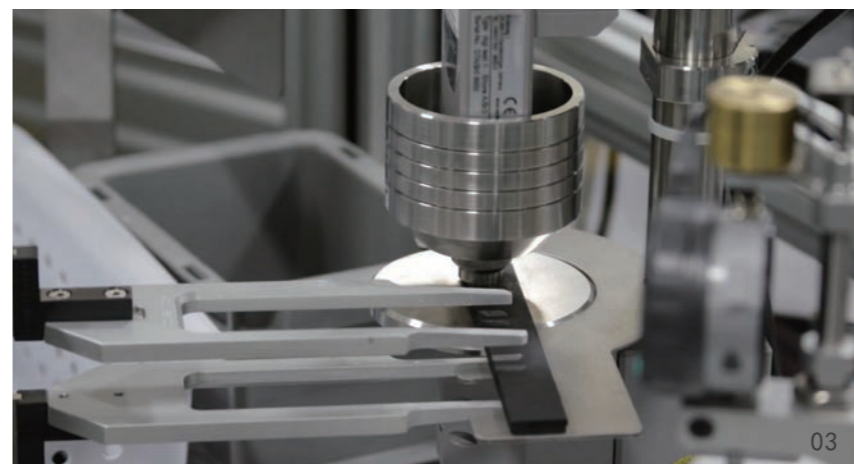
01 碳纤维夹爪 02 橡胶自动取样 03 集成硬度测试
